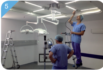
5 Test d'étanchéité des filtres (test DEHS / EMERY) Mesure des vitesses Mesures de la cinétique d'élimination
